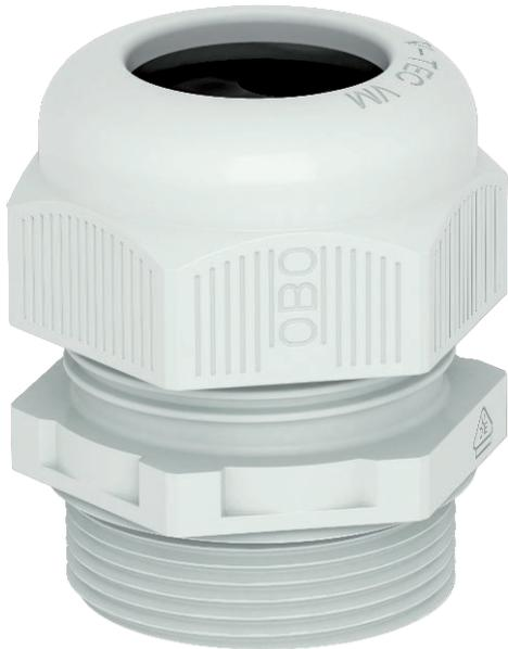
Kabelverschraubung mit metrischem Anschlussgewinde in Hutmutterbauart, für Kabelabzweiggkästen, Gehäuse, Verteilerschränke im privaten und industriellen Bereich. Mit Zugentlastung und integrierter Dichtlippe, geprüft nach DIN EN 62444. Schutzklasse IP68. Einsetzbar von -20°C bis +65°C.
