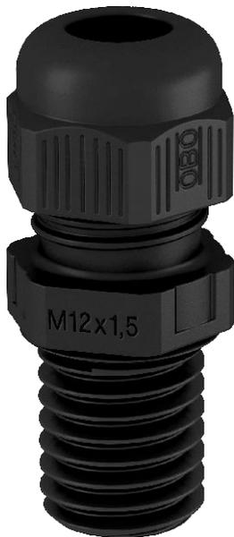
Die schnellste und bequemste Art mit Kabelverschraubungen an Kabelabzweigkästen und Gehäusen für Zugentlastung und Dichtigkeit zu sorgen: die bewährte V-TEC VM Kabelverschraubungen von OBO. Mit der integrierten Dichtlippe und speziellen OBO Lamellentechnik wird die Schutzklasse IP68 erreicht. Zugentlastung und Dichtigkeit sind geprüft nach DIN EN 62444.
