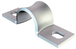
$\label{lem:mass} \mbox{Maße nach Siemens-Norm SN 78550 Form B, mit stark gerundeten Kanten, daher besonders für empfindliche Leitungen geeignet.}$
