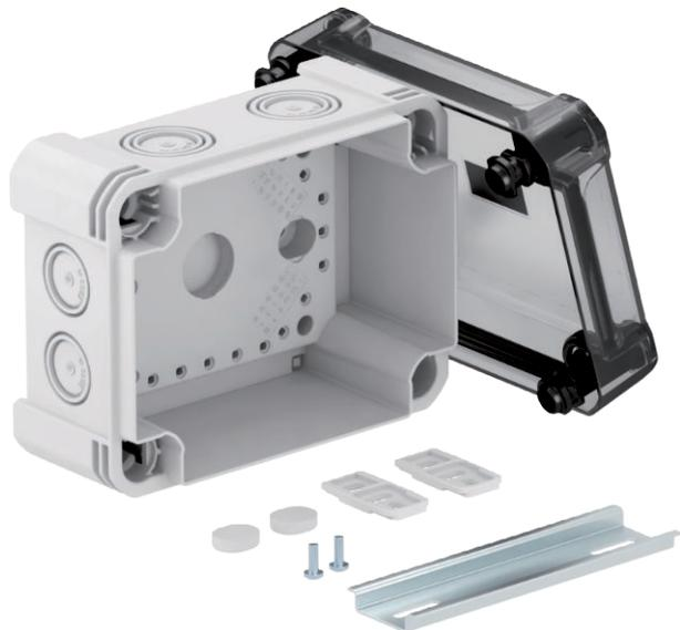
Kabelabzweigkasten mit Hutprofilschiene zum Verbinden von Kabeln und Leitungen im Innen- und Außenbereich. Rechteckige Form mit Ausschlageinführungen. Geeignet für die Wand-/ Deckenmontage mit der Möglichkeit zur Außenbefestigung, Innenbefestigung oder Montage über die Eckdome. Besonders schlagfest mit IK09. Transparenter Deckel mit Schnellverschluss, plombierbar. Hergestellt aus halogenfreien und UV-beständigen Materialien.
